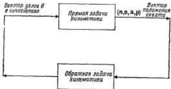
Рис. 2.2.3. Связь прямой и обратной задач кинематики манипуляторов.
