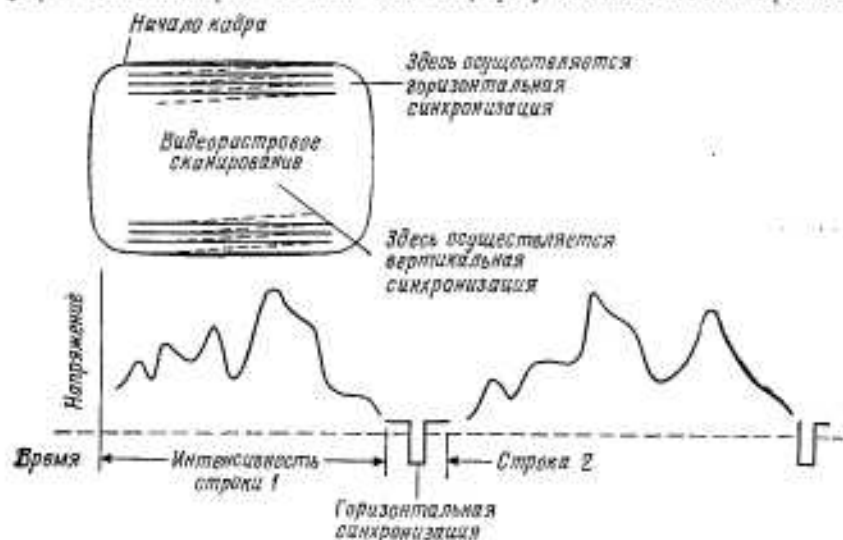
Рис. 8.3.8. Стандартный аналоговый видеосигнал. Каждая строка растрового сканирования пропорциональна яркости вдоль строки.
