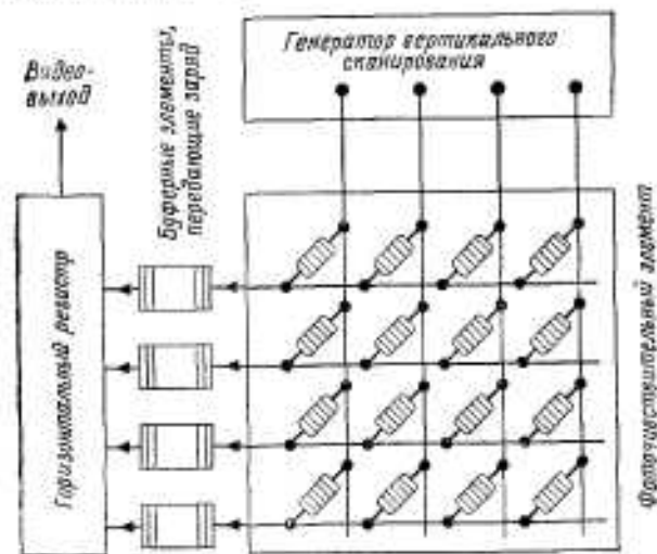
Рис. 8.3.7. Массив устройств с зарядовой инжекцией.
